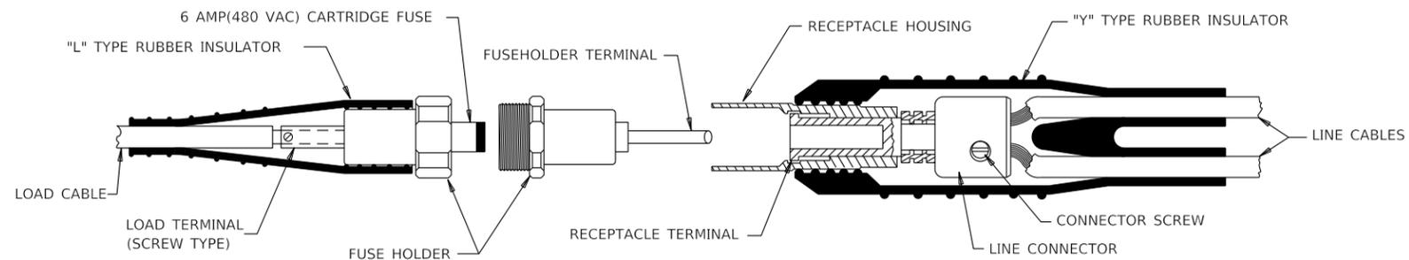
**DETAILS OF TYPE HEB-JW-RYC CONNECTOR**
